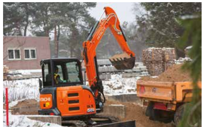
El radio de giro de la parte trasera reducido hace que la ZX55U-6 sea perfecta para trabajar en espacios limitados.
