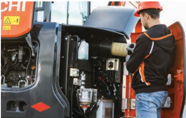
Los puntos de inspección diaria están agrupados para mayor conveniencia.
