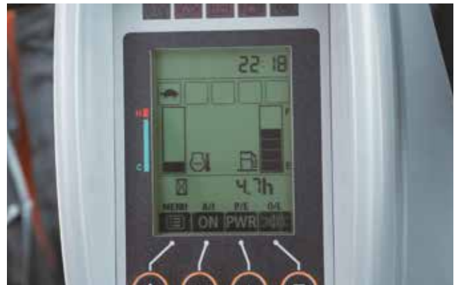
Monitor LCD multifuncional que muestra en un vistazo los datos.
