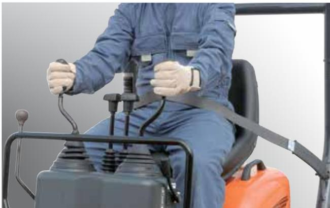
Las palancas de mando mediante pilotaje garantizan un funcionamiento suave.
